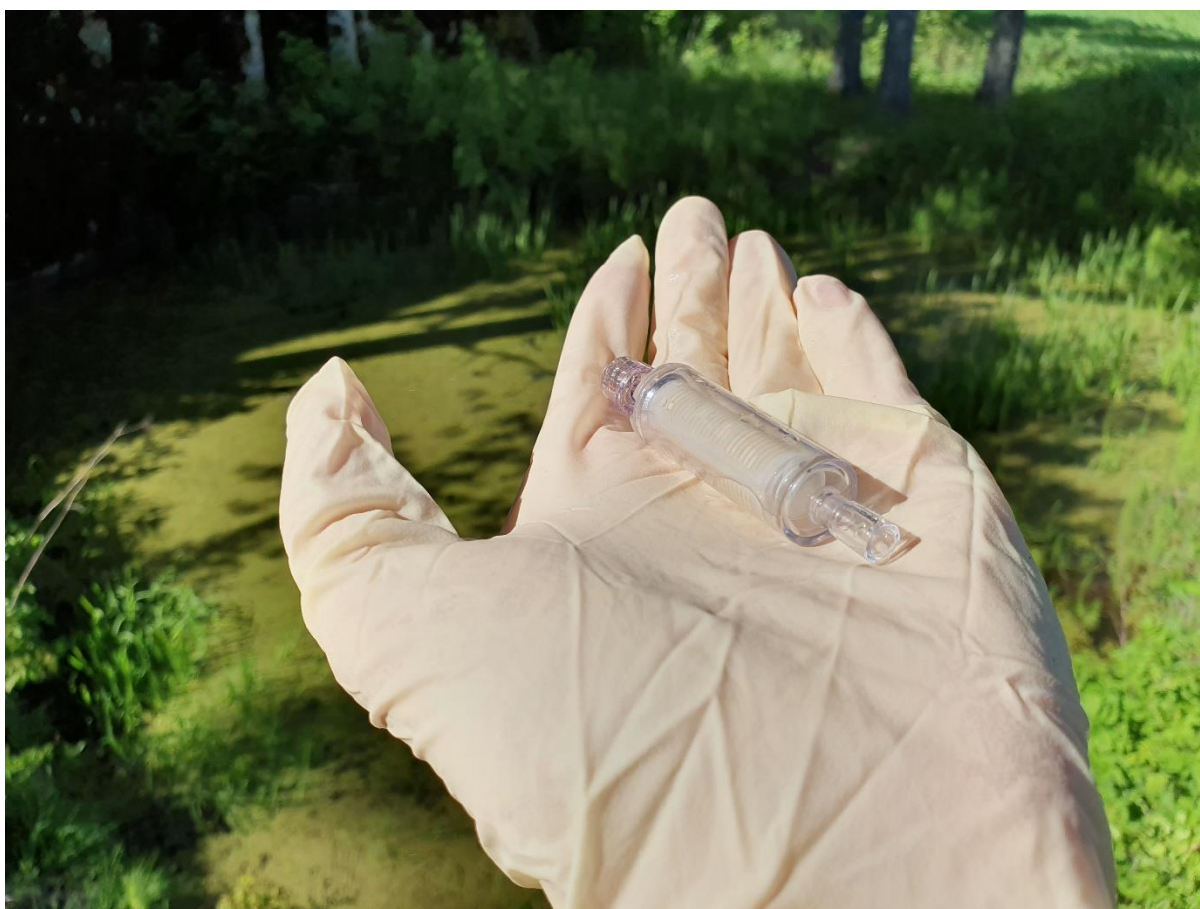
Figur 3. Denna modell av Sterivex-filtret används vid e-DNA provtagningen av fiskfaunan.
